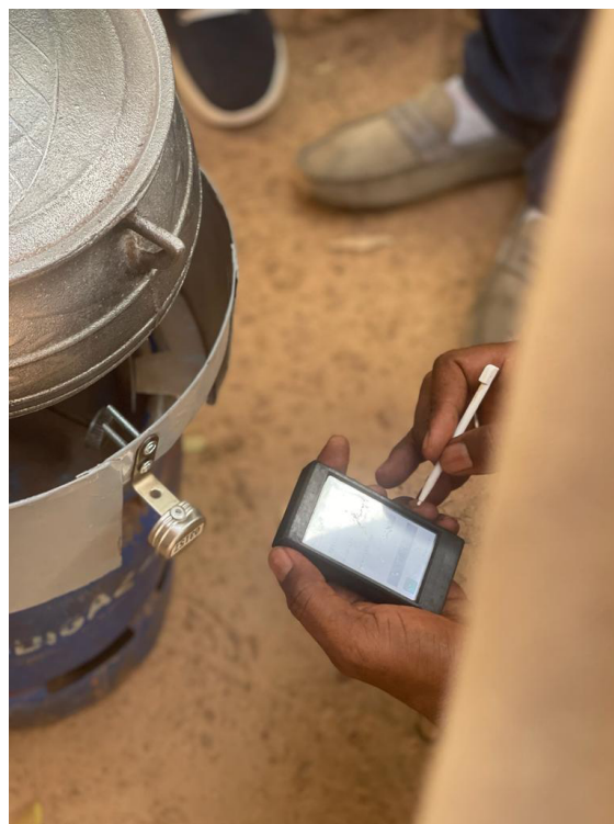
(b) Téléchargement des données du moniteur d'utilisation à l'aide de sa télécommande
