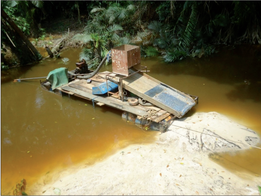
Photo 4. Unité de lavage de l'or dans un cours d'eau en Côte d'Ivoire
